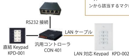
汎用コントローラにシリアル切替コマンドをマクロとして登録し、直結 Keypad 又は LAN 対応 Keypad のボタンから該当するマクロを起動します
