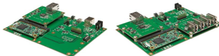
ローカル用評価ボード+Core モジュール +GMII モジュール
